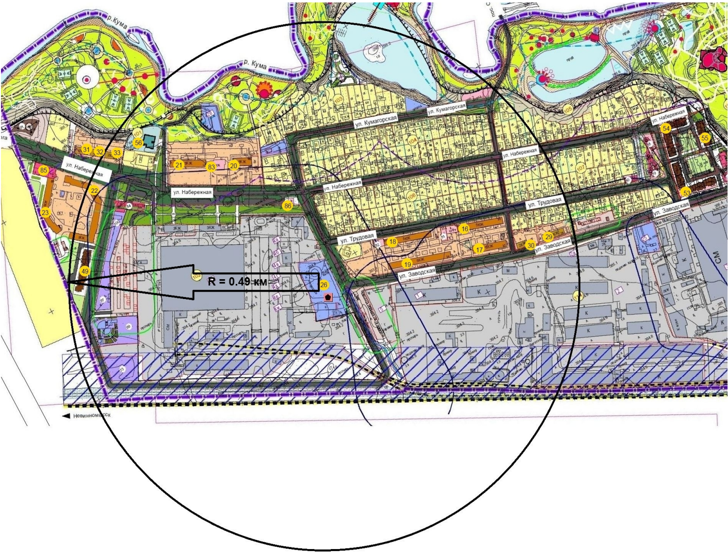
Рисунок 2.1.а. - Схема радиуса эффективного теплоснабжения источника тепловой энергии, котельная 26-12.
